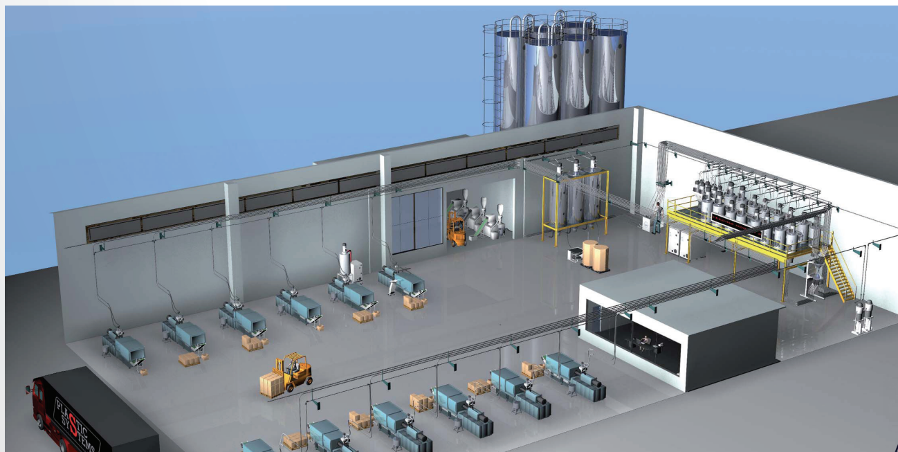
Beispiel zentrales Materialfördersystem Matrix
